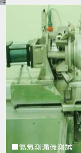
■氮氣測漏儀測試
